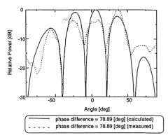
図 11 注入同期された2素子アクティブアレイアンテナのE面放射界 の測定値及び計算値
