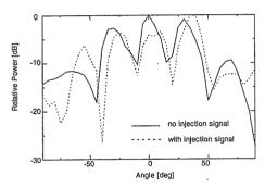
図 10 注入同期された2素子アクティブアレイアンテナのE面放射界
