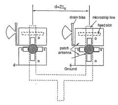
図8 パッチによるアクティブアレイアンテナの構成
