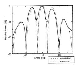
図 9 2 素子アクティブアレイアンテナのE面放射界
