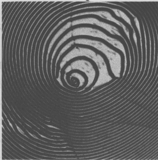
図 4-11 渦状テクスチャ (温度 90^{\circ}\text{C} , 電界 33.3\text{ V/cm} )
