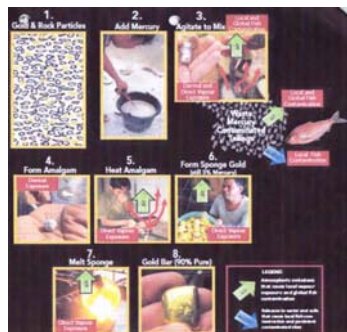
写真 1 小規模金採掘現場で水銀使用の一般的な作業工程
