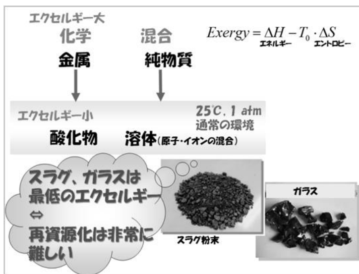
Fig.1.10 金属と酸化物ならびに純物質と混合物のエクセルギーの比較
