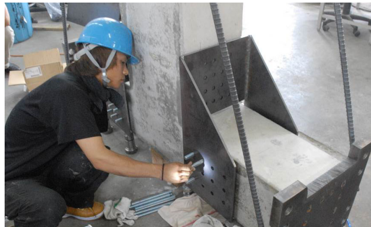
(b) デバイスを装着後にアンカー設置
