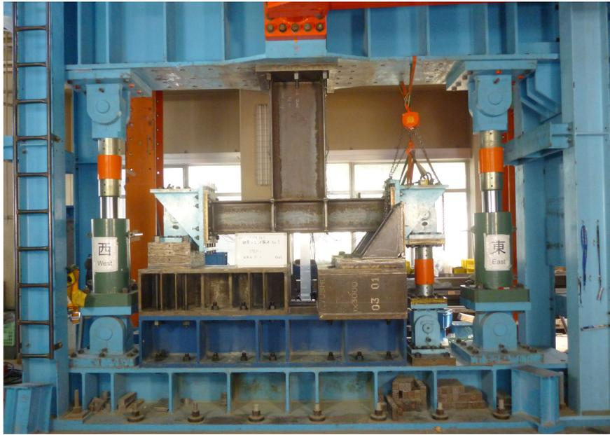
写真 2.3.1 鉄骨造試験体設置の様子
