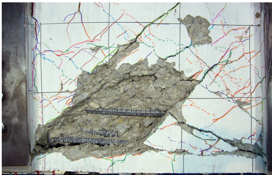
(b) 接合部パネルの拡大写真
