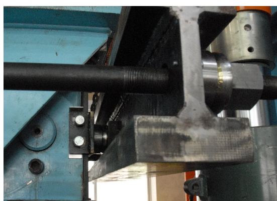
(d) 詳細写真：治具 B と柱端の接続
