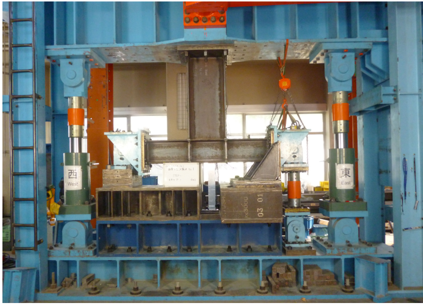
写真 2.3.1 鉄骨造試験体設置の様子
