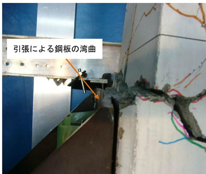
(a) 引張側デバイスの損傷
