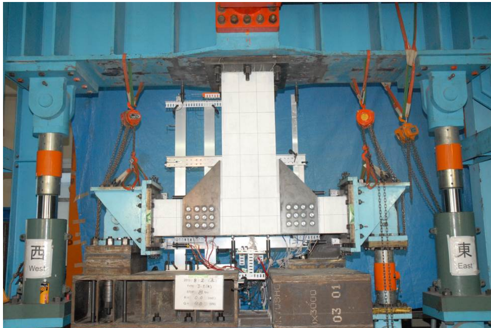
写真 4.5.1 試験体設置の様子
