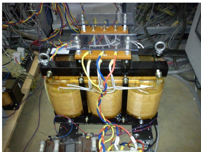
図 5-6 変圧器(207V/460V 漏れリアクタンス 9.1%)
