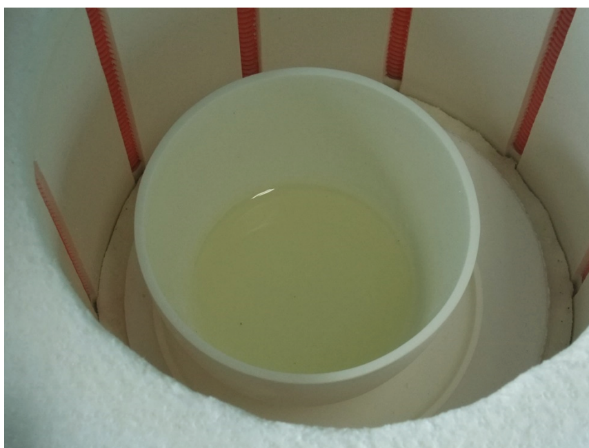
図 4.4 温度調整により一様に溶融したガラス (炉温度 655°C)
