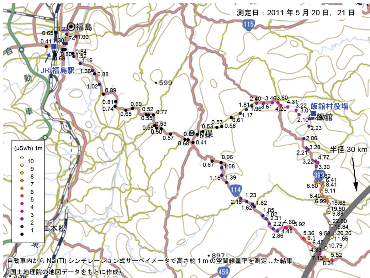
図 1.2 事故から約 2 か月後の空間線量率の走行サーベイによる測定結果
