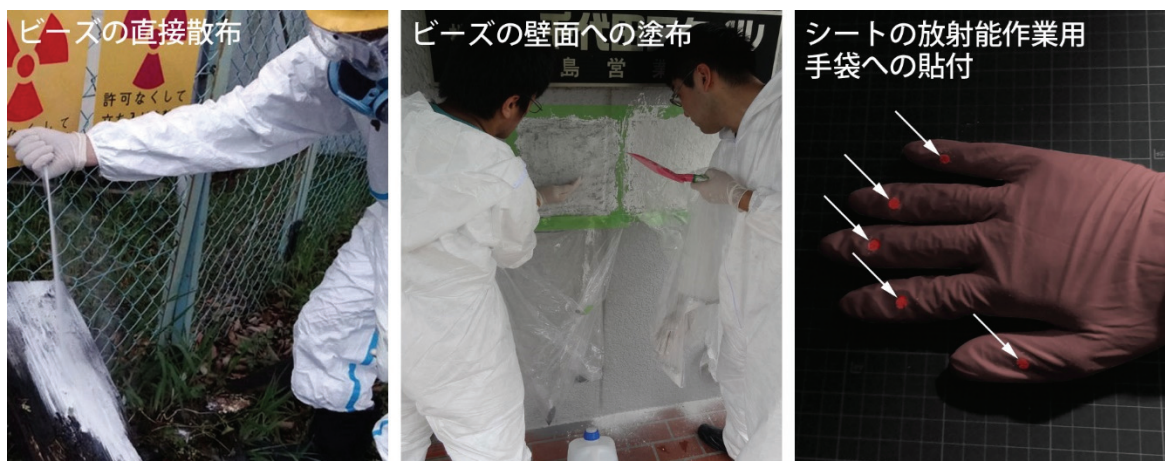
図 5.2 ビーズ型やシート型蛍光ガラスの放射能汚染モニタリング（試験）への適用の様子
