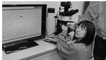
写真3. 余寿命診断の手掛かりになるクラックを探す [撮影者] PET 従業員
