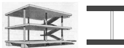
図1 「ドミノ」(1914)の架構システム
