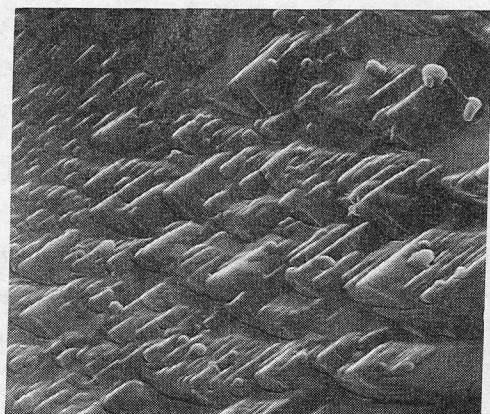
図3 磁気を照射された溶液から成長した結晶のSEM写真 — 0.5 \mu\text{m}
