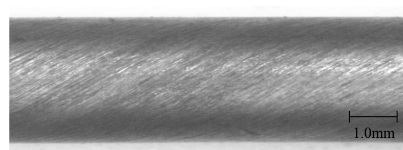
極低温・ダイス半角 6^\circ ・ \Delta T \leq 160\text{K} 線径 2.66mm \varepsilon=2.20
