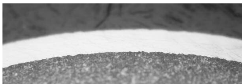
c) 断面減少率 0%、めっき厚さ 30μm
