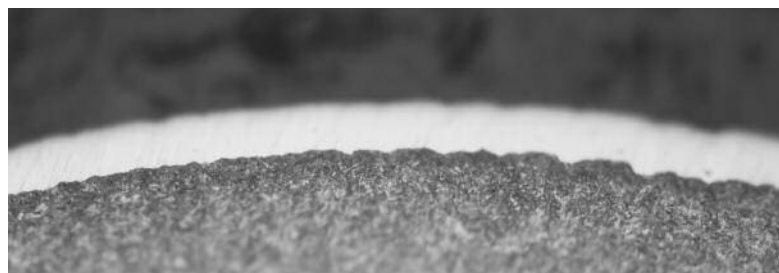
e) 断面減少率 10%、めっき厚さ 20μm
