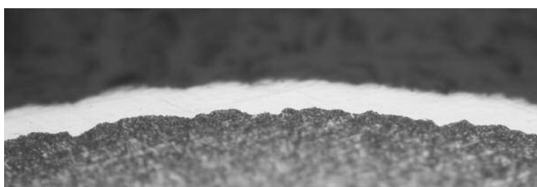
a) 断面減少率 0%、めっき厚さ 15μm
