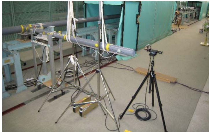
図 5. 2 トンネル枝坑模型設置状況
