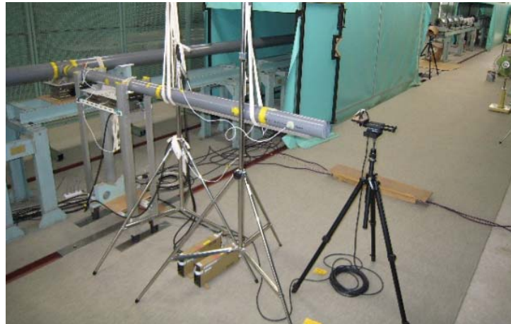
図 5. 2 トンネル枝坑模型設置状況
