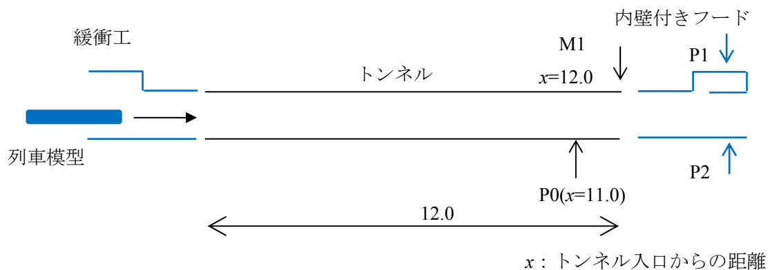
図 5. 1 2 トンネル模型と測定位置
