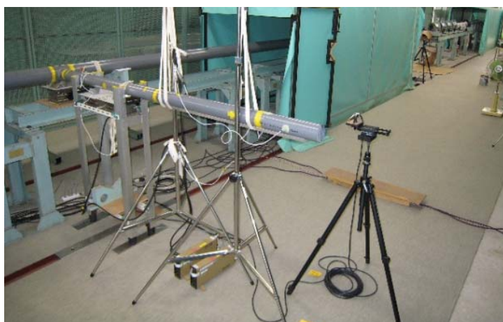
図 5. 2 トンネル枝坑模型設置状況
