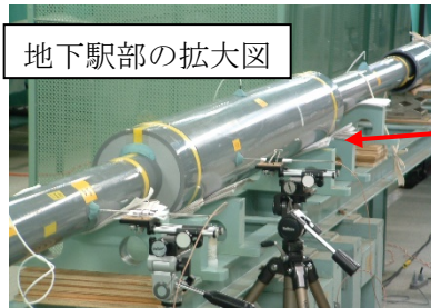
(a) 実験 1 : トンネル拡大部検証実験
