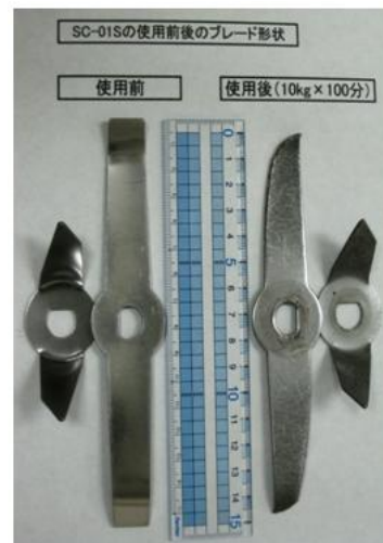
写真 4-6 破碎前と 約 100 台×100 分 破碎後のブレードの形状
