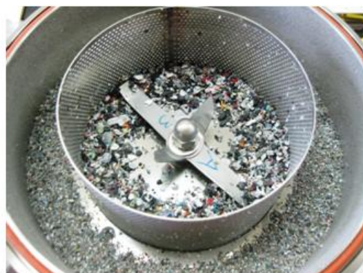
写真 4 - 9 携帯碎片 200g を 30 秒破碎した後 の 3mm φ スクリーンによる分級・分離状況
