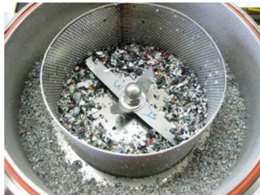
写真 4 - 9 携帯碎片 200g を 30 秒破碎した後 の 3mm \phi スクリーンによる分級・分離状況
