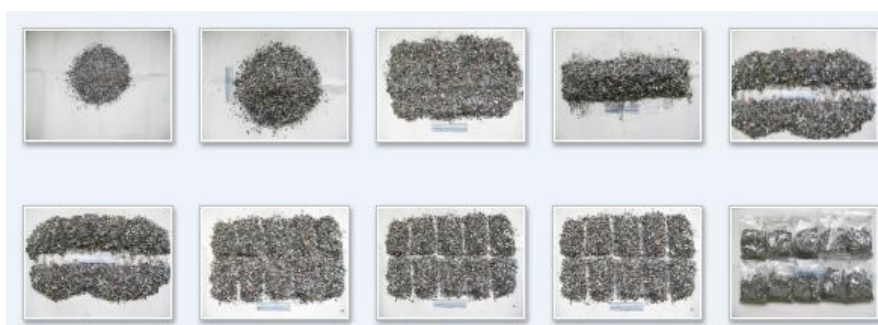
写真 4-3 一次破碎碎片を二次破碎の試料にする縮分分割操作 (200g×10 個の試料を作る操作の例)
