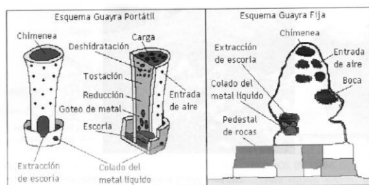
図 2-20 先住民の Guayra 法の種類 (左は持込型、右は定置型) 57)
