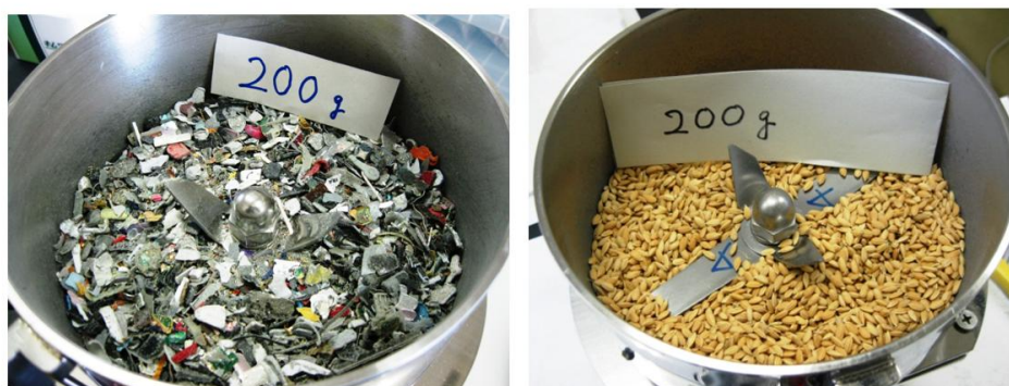
写真 4 - 5 SC-01S に携帯砕片と粃米の 200g を装填した時の ブレードとの相対位置関係
