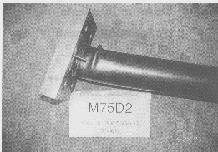
写真 7 - 2 (b) M75D の端部局部座屈状況
