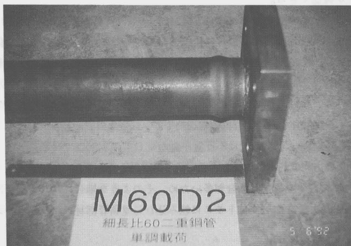
写真 7 - 2 (a) M60D の端部局部座屈状況
