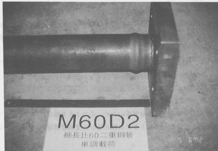
写真 7 - 2 (a) M60D の端部局部座屈状況
