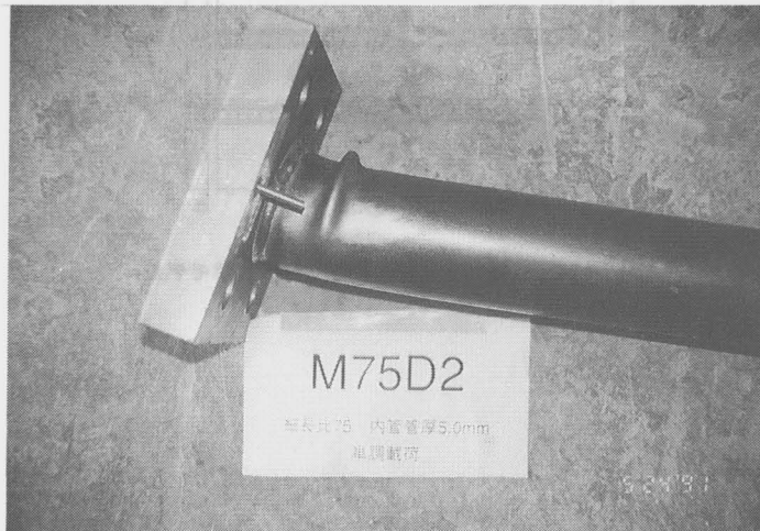
写真 7-2 (b) M75D の端部局部座屈状況
