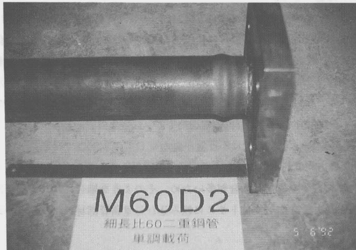
写真 7-2 (a) M60D の端部局部座屈状況
