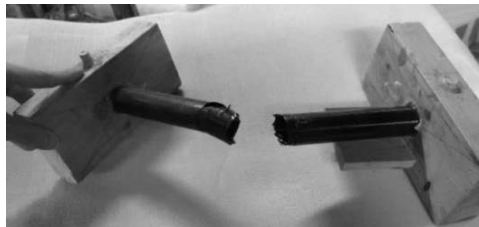
図 5：破壊された試料
