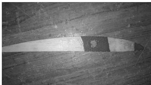
(I)前縁、後縁、桁穴に CFRP(肉抜きなし)
