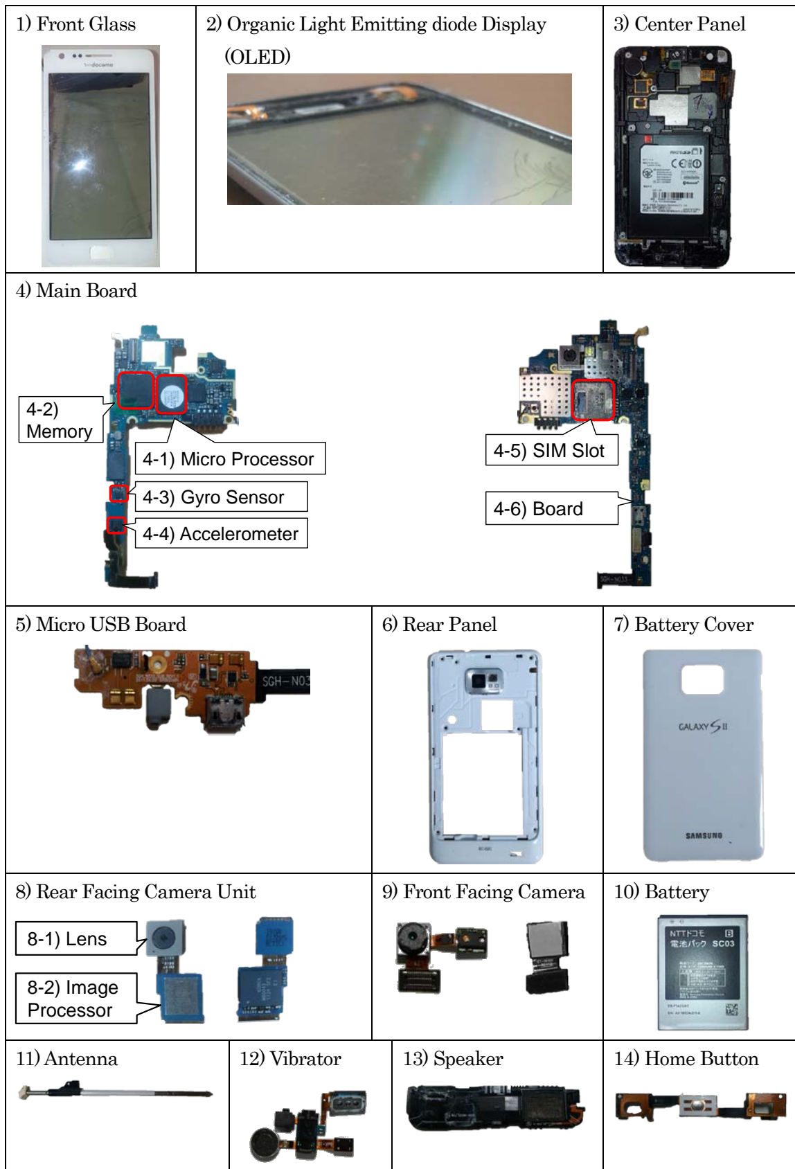
図 7-1 : Galaxy S II の分解調査を通じて特定したスマートフォンの部品構成
