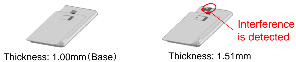
図 7-28 : Center Panel の厚みを増加した場合の干渉判定
