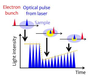
図 3-2-8 ストロボスコピック法の原理
