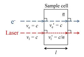
図 4-1-1 サンプルセルを通過する電子ビームとレーザーの速度差
