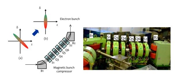
図 3-2-5 磁気パルス圧縮器の原理と写真
