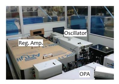
図 3-2-7 Ti:Sapphire フェムト秒レーザー
