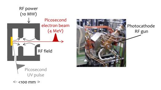
図 3-2-3 レーザーフォトカソード RF 電子銃の原理と写真
