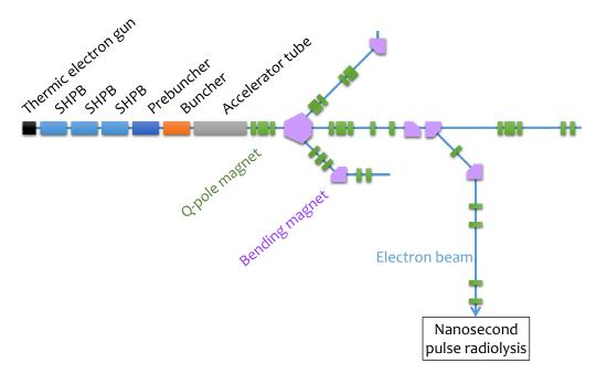
図 3-3-1 L-band ライナックの概略図
