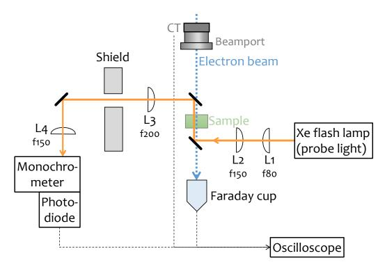
図 3-3-2 ナノ秒パルスラジオリシスシステムの構成 CT: カレントトランスフォーマー; L1~L4: 石英レンズ( $\phi$  = 50 mm, 図中の f 値はレンズの焦点距離);
