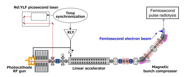
図 3-2-1 S-band レーザーフォトカソード RF 電子銃ライナックの概略図
