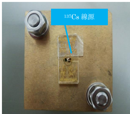
(a) ^{137}\text{Cs} 線源を取付けたコリメータ
