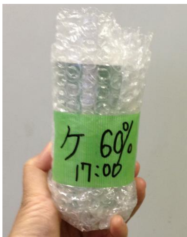
写真 3.2.2 断熱材で覆った供試体
