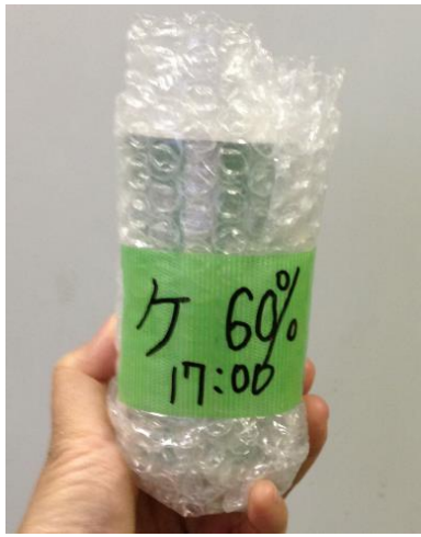
写真 3.2.2 断熱材で覆った供試体
