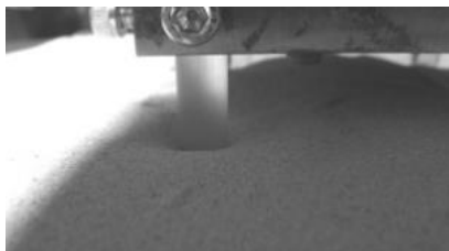
(a) 杭周地盤のくぼみ (改良地盤なし・加震終了後)
