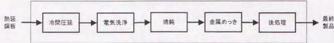
図 4-2-1 対象工場の主要な製造プロセス
