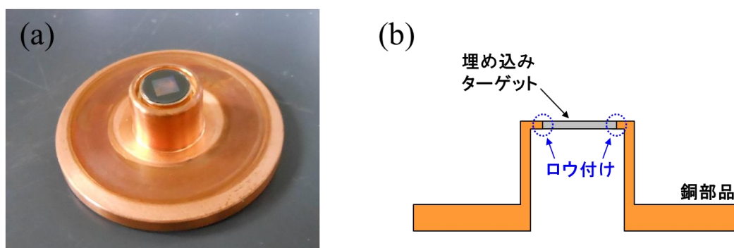
図5 (a)ターゲットユニット (b)ターゲットユニットの構造
