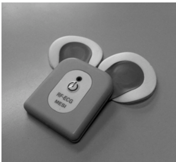
図 5-7 ワイヤレス生体センサー「RF-ECG」
