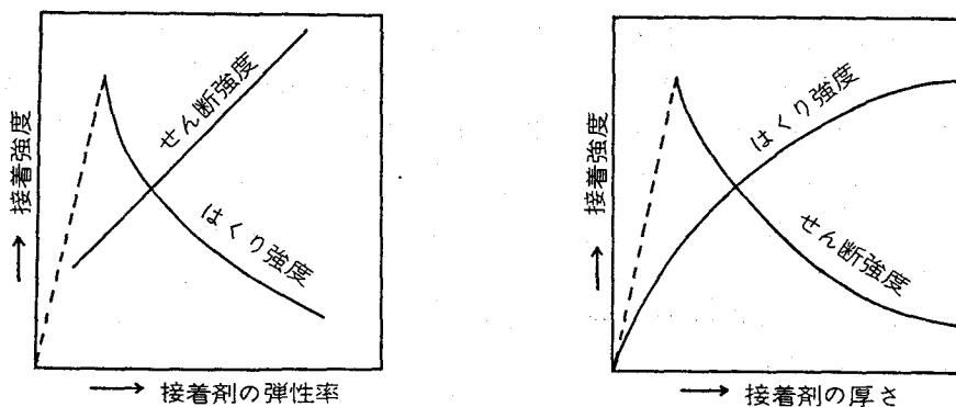
したがって、いずれか一つの接着強度だけが問題になる場合は接着剤の選択が容易になる。たとえばせん断強度はナイロンのホットメルトとエポキシ系接着剤とで殆んど変わらないが、はくりと引張りに対してはナイロンの方が  $10 \sim 20$  倍強力である。
