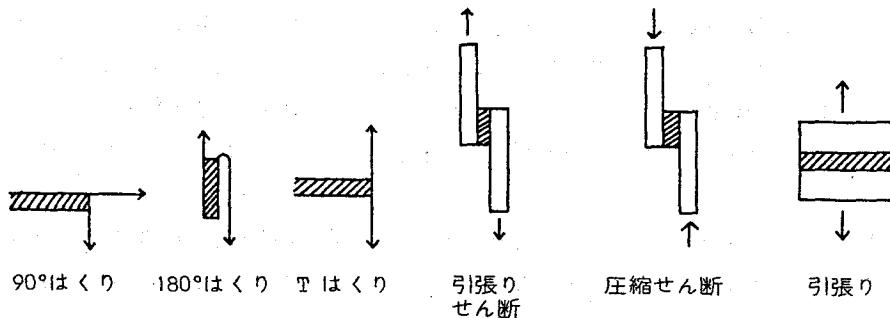
硬化後の接着剤が硬くて弾性率が大きいほどせん断強度は大きくなるが、はくり強度は逆に小さくなる。一方、柔軟で強靭な接着剤では、はくり強度が大きい。曲げと衝撃強度は、はくり強度と同じ傾向を示す。接着剤の層は厚いほどはくり力に強いが、せん断力に対しては弱くなる。
