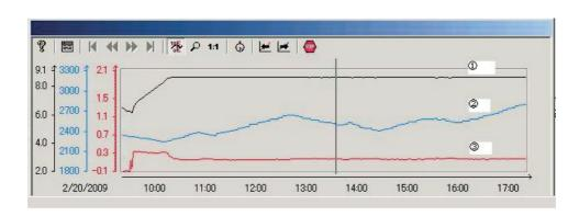
図3.回収へリウムガス純度向上の結果(内部精製液化運転時のモニター画面のコピー) Buffer Tank圧力(bara) Liq He貯槽液量(ℓ) Regeneration差圧(SP: > 2.0 bara) この図は、回収へリウムガス純度99.95%He(酸素濃度計測定換算)の時、約8時間の運転で 差圧(線不純物の蓄積)が、発生することなく連続して精製液化をしたことを示している。
