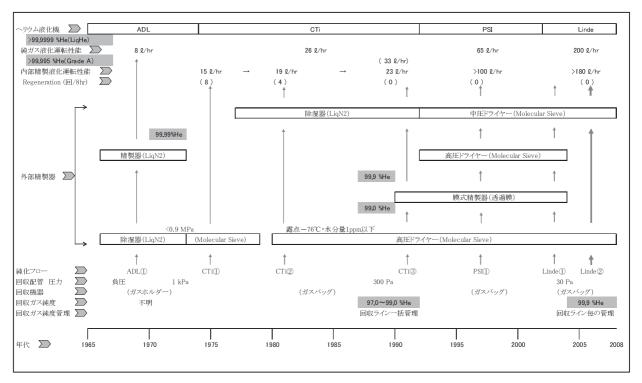
図1.年代別回収ガス純化フローとガス純度
