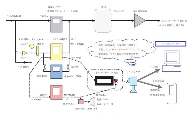
図2.回収ヘリウムガス純度管理フロー
