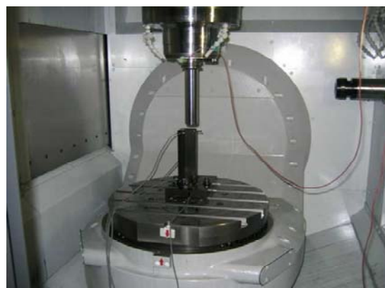
図5.3 静剛性の測定システム
