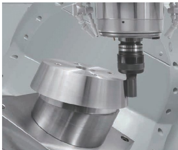
図6.1 NAS979に基づいたテーパコーン試験法による加工テスト
