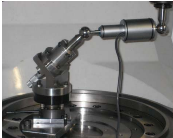
図6.3 新たに開発されたDBB5測定装置
