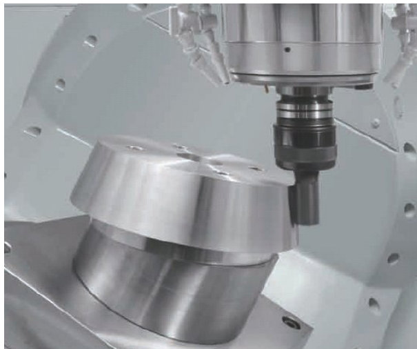
図6.1 NAS979に基づいたテーパコーン試験法による加工テスト
