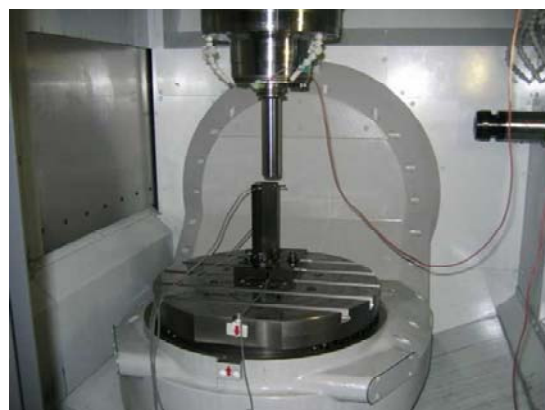
図5.3 静剛性の測定システム
