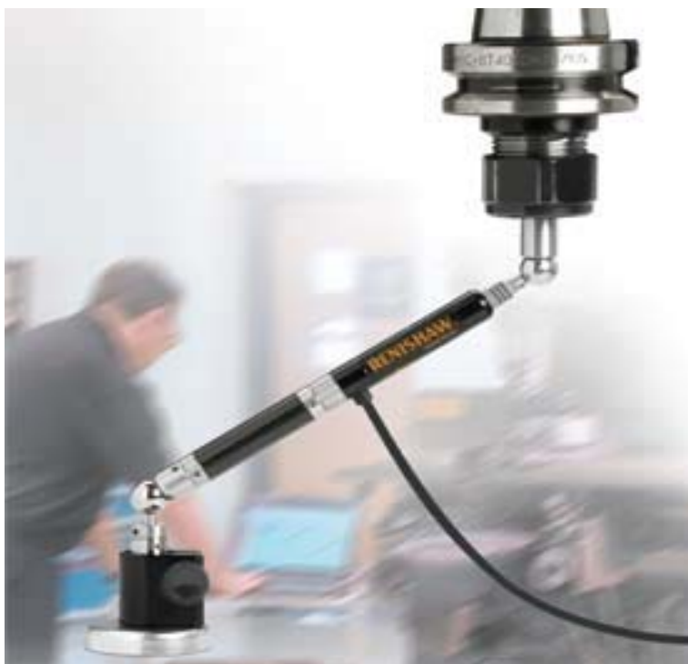
図6.7 従来のDBB3測定機（Renishaw社製）
