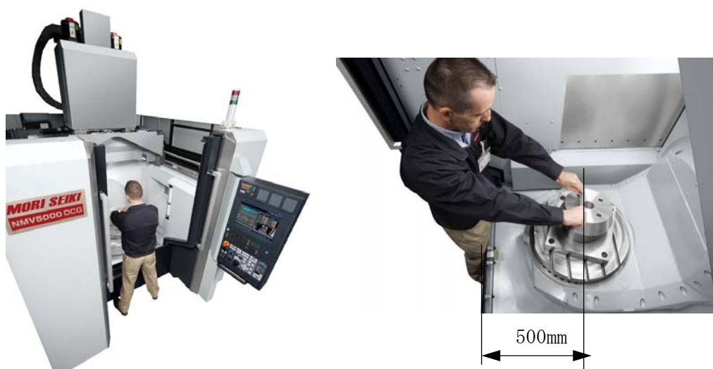
図4.9 片持ち支持構造によるオペレータ接近性の良さ
