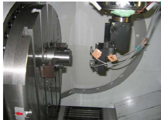
図5.6 C軸テーブルの熱変位測定のセッティング
