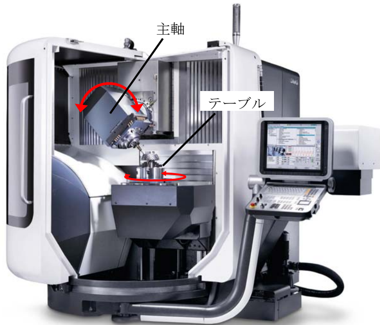
図2.4 主軸 1 軸首振り型の全体構造
