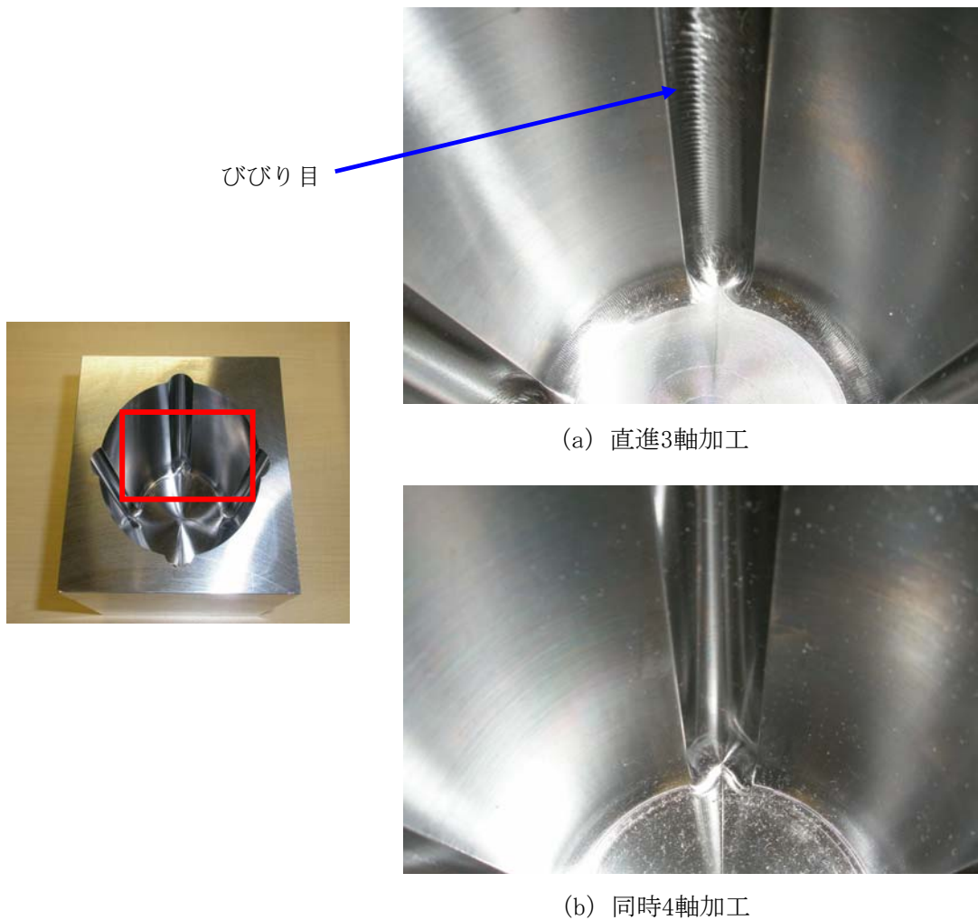
図7.18 2つの方法で加工した複雑断面円錐形状ワークの仕上げ面
