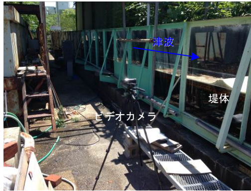
(a) 水路および堤体の撮影状況
