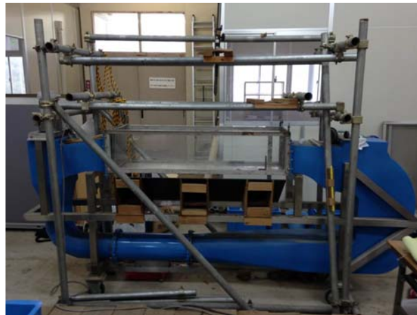
図 5-8 実験に用いた循環水槽の写真
