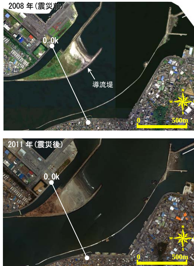
図 4-10 東北地方太平洋沖地震津波前後の河口砂州の空中写真
