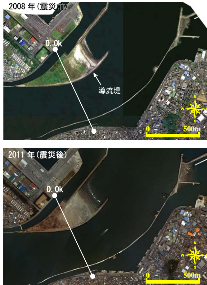
図 4-10 東北地方太平洋沖地震津波前後の河口砂州の空中写真
