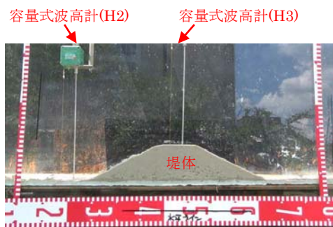
(e) 堤体と容量式波高計の設置状況
