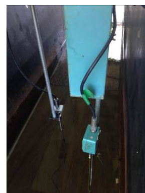
(f) 沖側の容量式波高計(H1)と電磁流速計の設置状況
