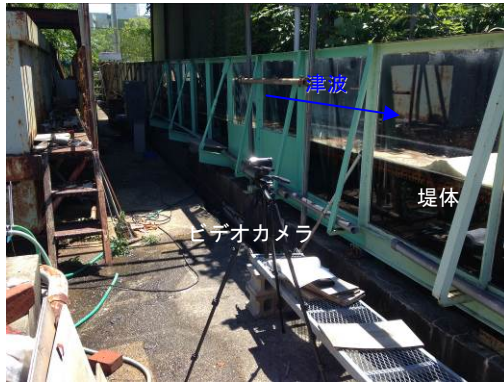
(a) 水路および堤体の撮影状況
