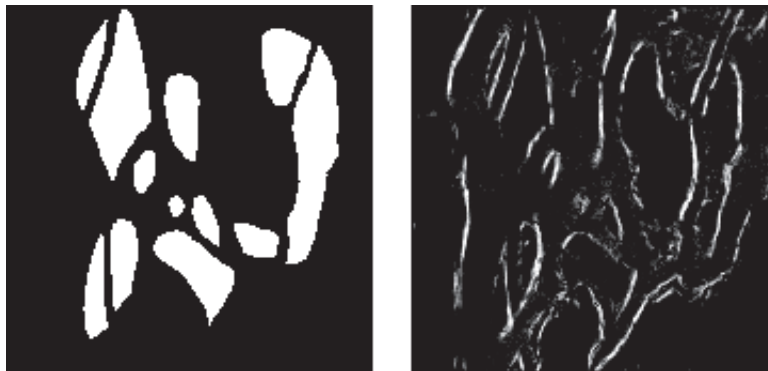
図 5.5: 画像番号 4 に対する本手法の例 (特徴量としてガウスウェーブレット, スケールパラメータ (1, 2, 4, 8, 16) とモーメントを利用) (左) 真値 (右) 本手法の認識結果
