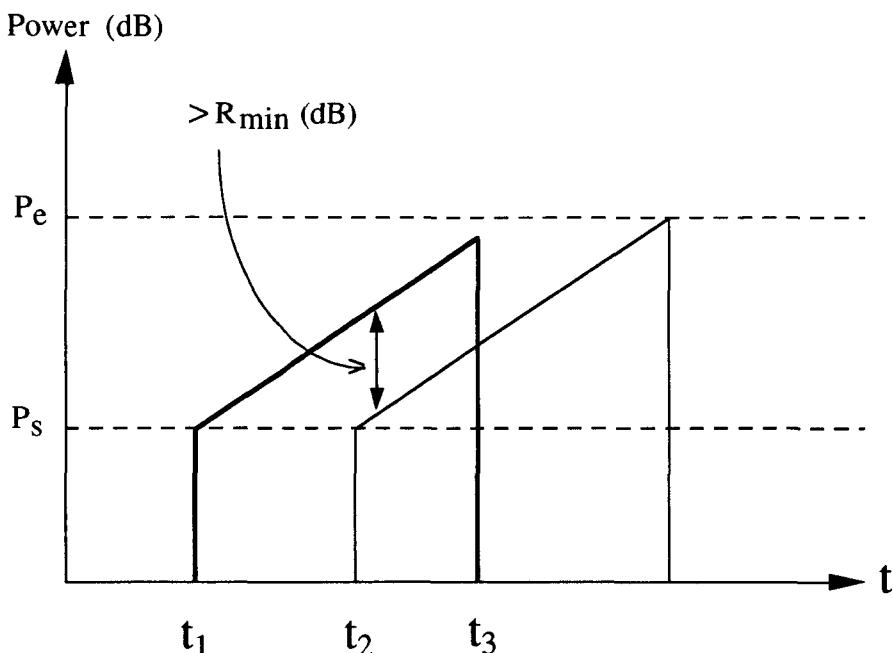
図 3-1 時変出力制御方式の原理
