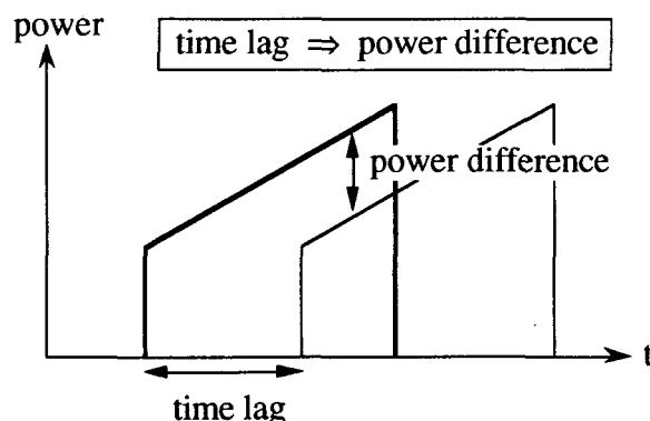
図5-1 到着時刻による受信パワー差の生成
