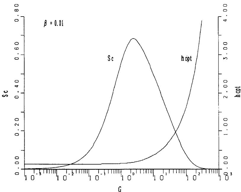
図 5-10 最適捕捉区間長とスループット性能
