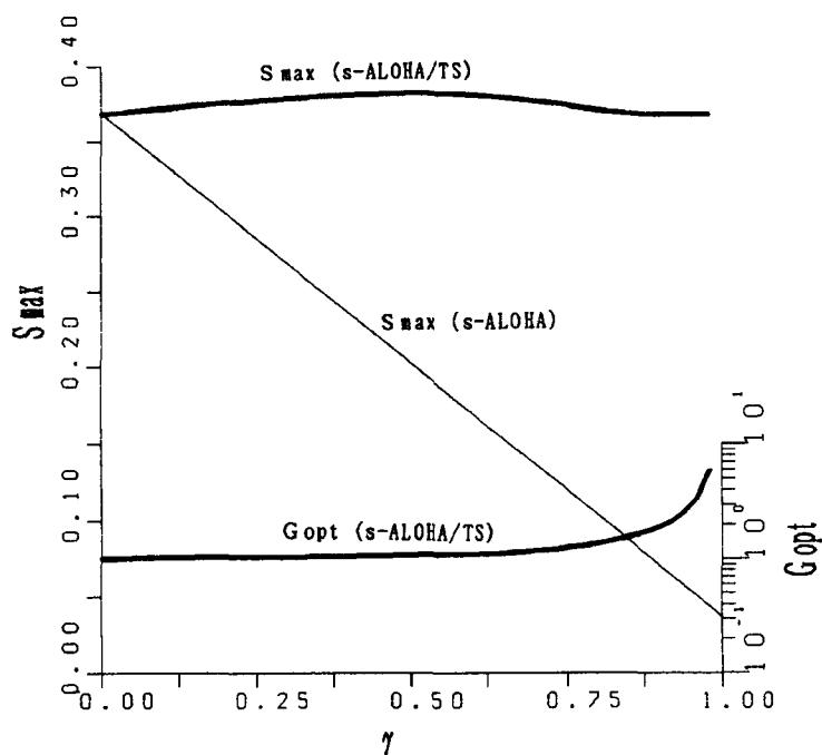
図5-12 制御パケットの比率 $\gamma$ に対する最大スループットおよび最適トラヒック
