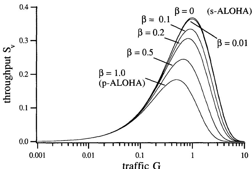
図 4-4 相対捕捉時間による性能
