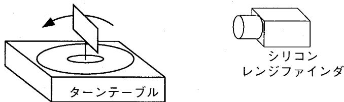
図 4.27 回転角追跡実験の機器構成
