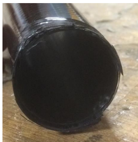
図 3 圧縮側に部分積層したパイプ
