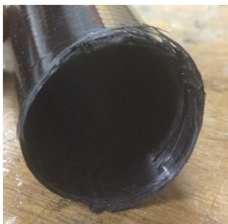
図 2 引っ張り側に部分積層したパイプ
