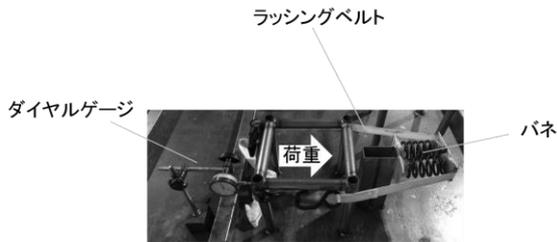
Fig.2 曲げ剛性試験概念図
