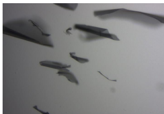
図 7 剥離した薄膜の液中での様子
