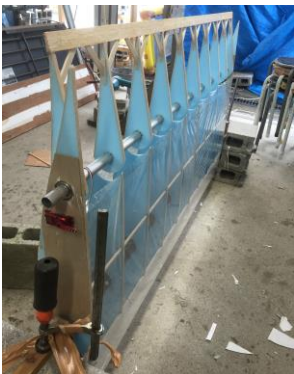
図 1：幅 1m のエレボン搭載翼
