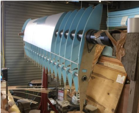
図 2：幅 3m のエレボン搭載翼
