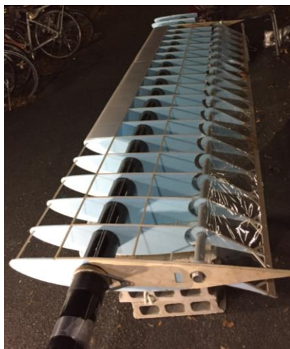
図6 幅3mのエレボン搭載翼動作試験
