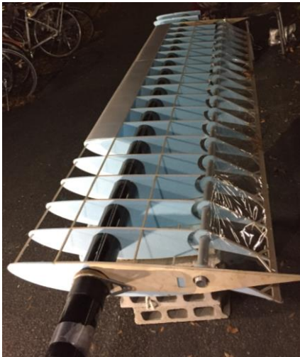
図 6 幅 3m のエレボン搭載翼動作試験
