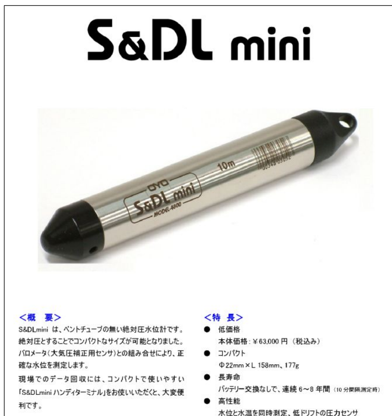
図-4.2.10 水位計「S&DLmini」の概要 （応用地質株式会社：小型絶対圧水位計 カタログより）
