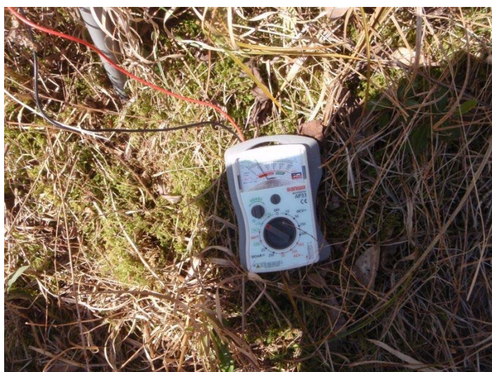
写真-4. 2. 12 観測井（手動）地下水測定状況
