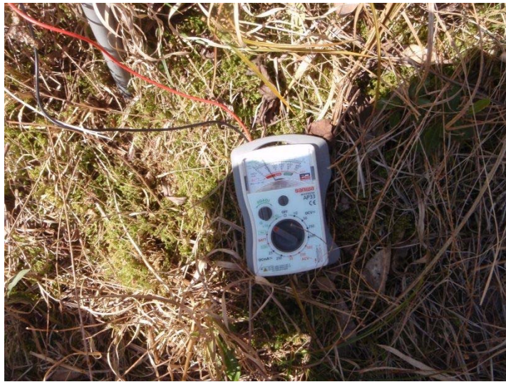
写真-4. 2. 12 観測井（手動）地下水測定状況
