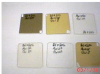
図 a-2-1 SC ターゲットを用いてガラス基板上に成膜したときの外観写真
