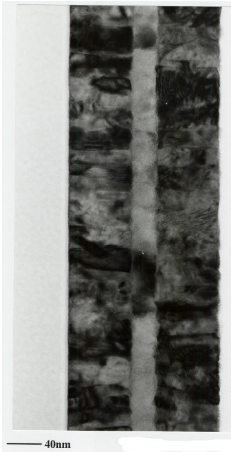
図 a-3-6 (b) 3層試料 (Mo(70 nm)/GSTB(30 nm)/Mo(70 nm)) の TEM 断面観察
