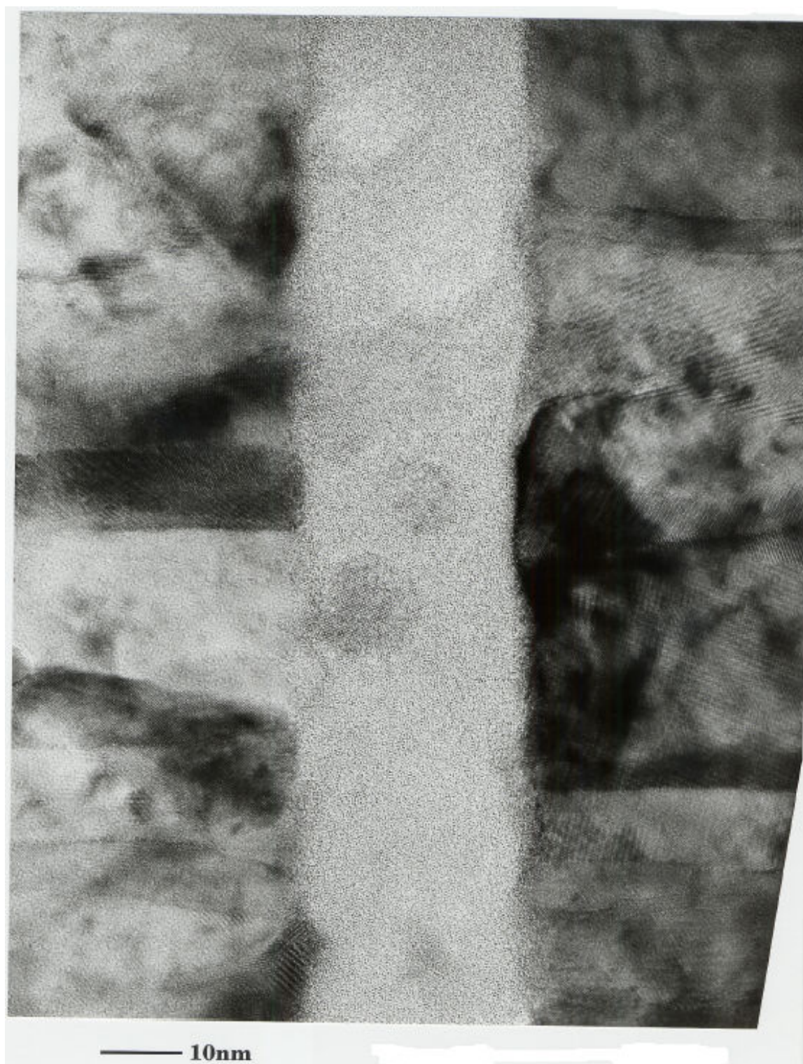
図 a-3-6 (c) 3 層試料 (Mo(70 nm)/GSTB(30 nm)/Mo(70 nm)) の TEM 断面観察 (拡大図:×2000,000: 多波干渉像): 両側が Mo、中心部分が GSTB
