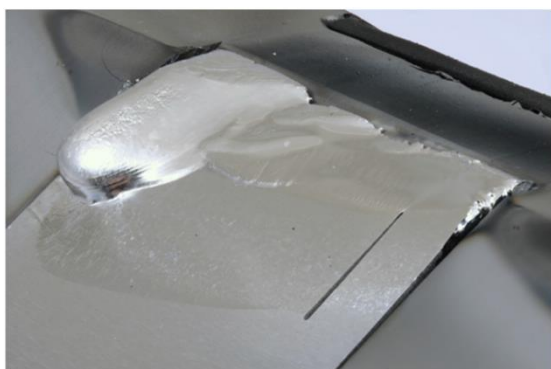
図 3.8 TEXTOR プラズマ曝露後のタングステン試料の表面状態 (a) pure W, (b) W-Ta 合金 ([31]より抜粋)
