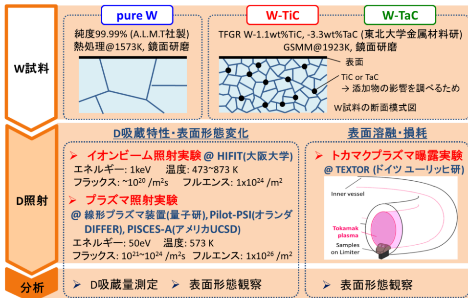
図 4.1 本研究の実験手順 (タングステン試料・重水素照射・分析)
