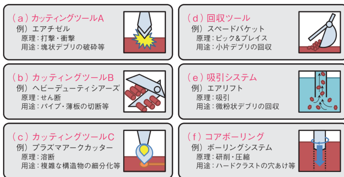
図 2-2 取出し装置の分類 (参考文献から抜粋[2.1])
