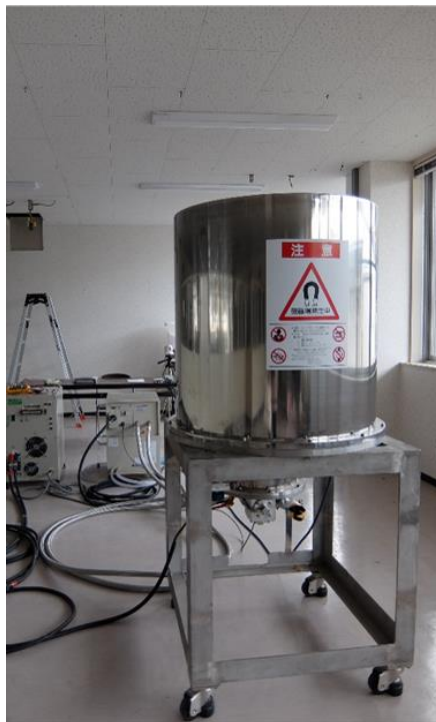
図 4-10 現地に導入した超電導磁石の写真
