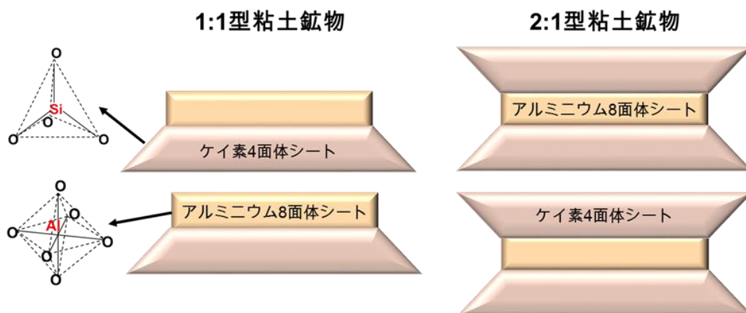
図 3-4 粘土鉱物の概念図 7)
