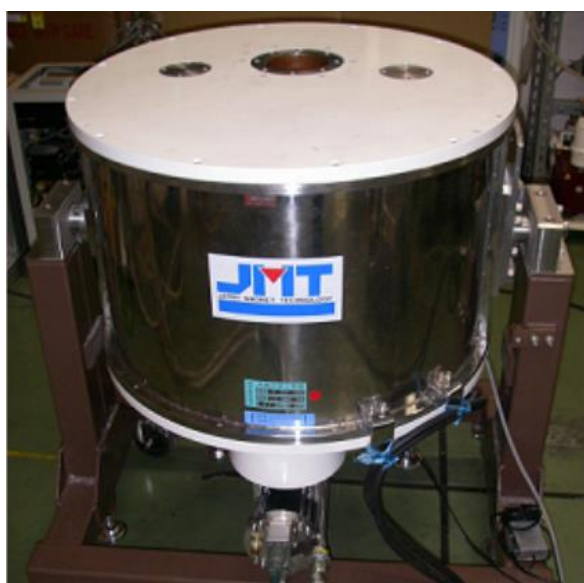
図 4-1 超電導ソレノイド磁石の外観
