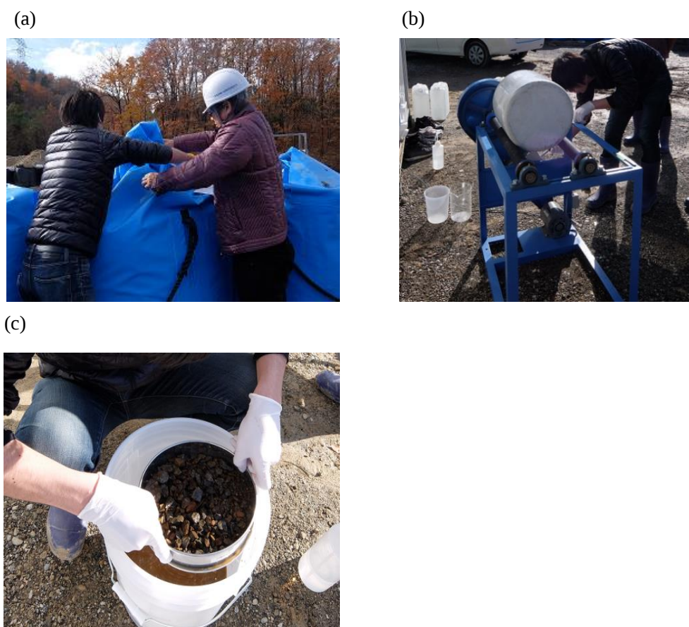
図 3-17 実験の様子；(a)土壌のサンプリング，(b)土壌研磨・Cs 移行処理，(c)湿式分級
