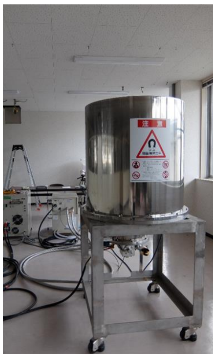
図 4-10 現地に導入した超電導磁石の写真
