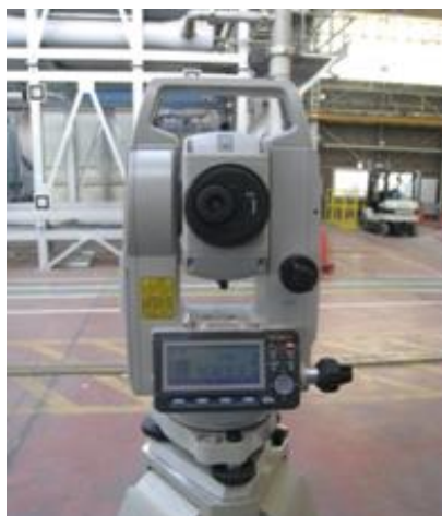
図 3.3.2 マーカ測位に使用したトータルステーション
